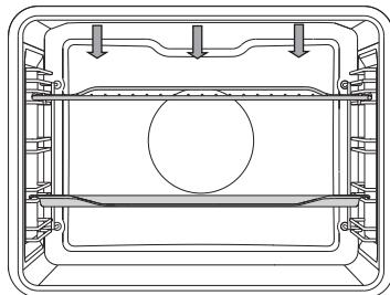
При **большом гриле** включаются верхний нагревательный элемент и инфранагреватель, расположенные под потолком духовки.
